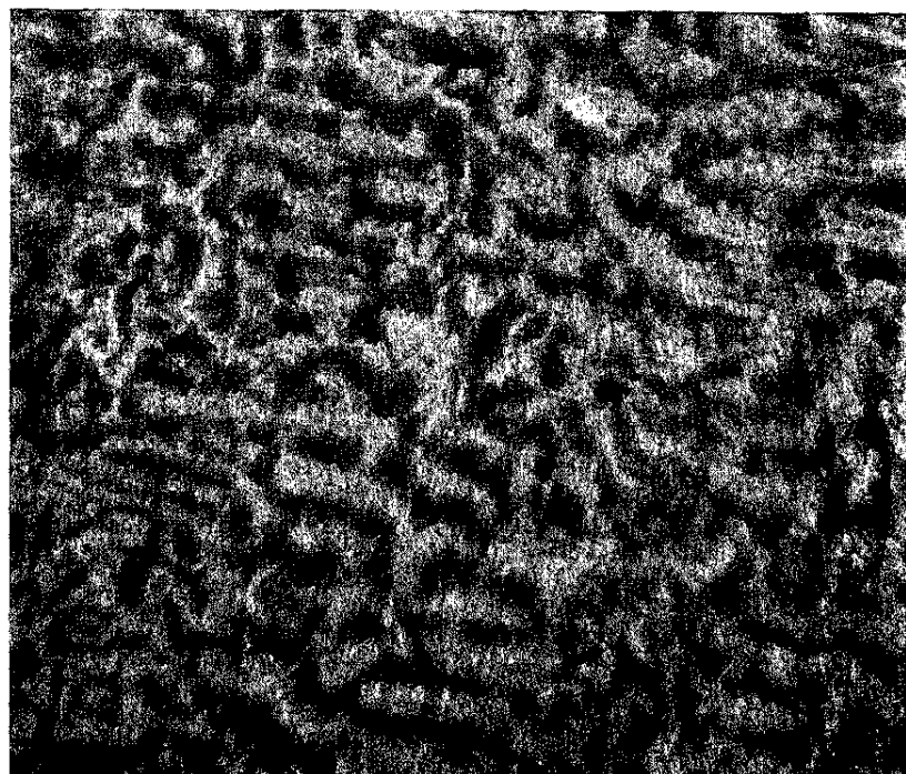
Фиг. 28. Картина осаждения магнитной суспензии на шлифованной поверхности образца «Б» Богуславского метеорита. До отжига. Место (4), увел. 210.
